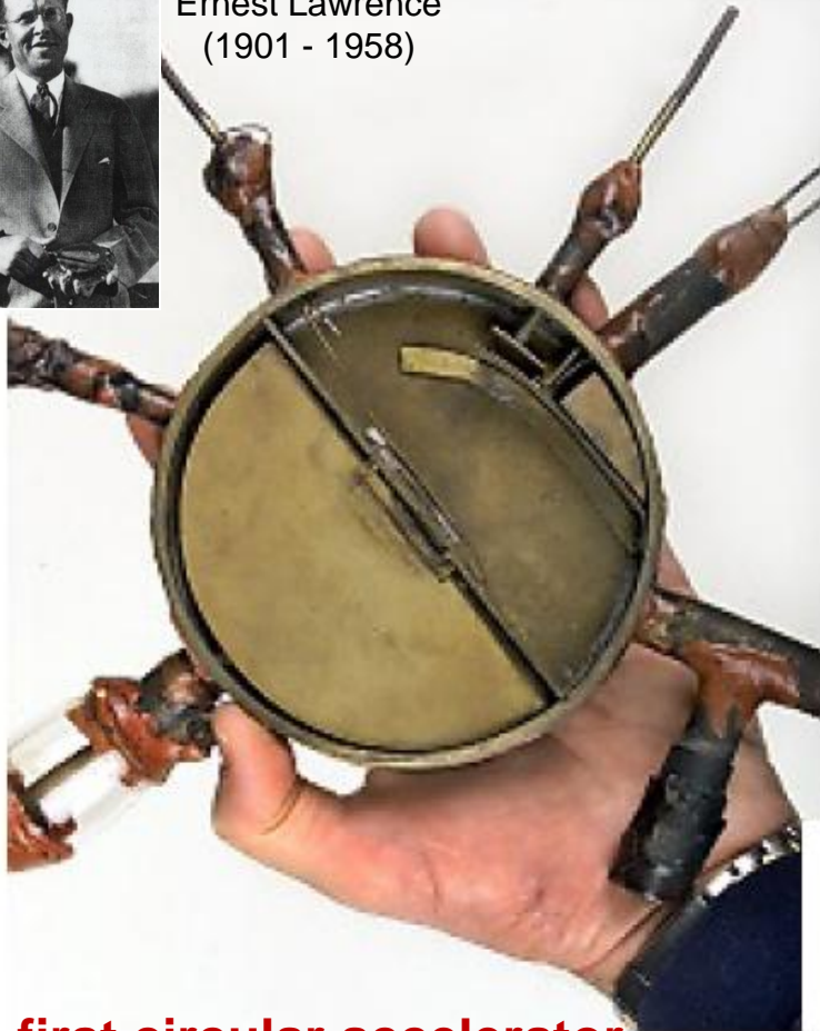
The first circular accelerator (Berkeley 1930)
