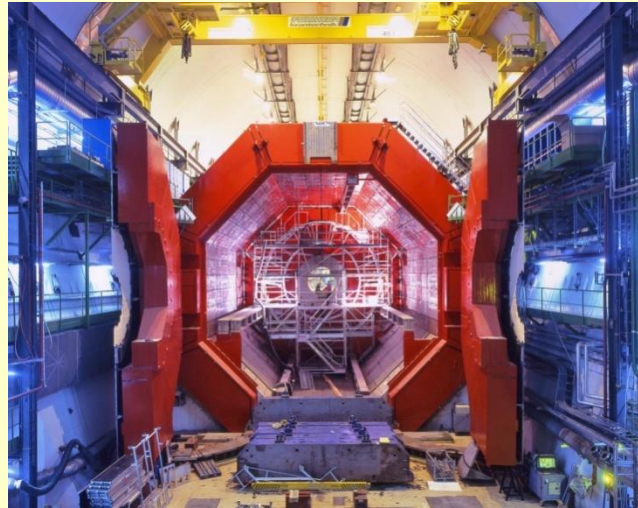
Jeden z největších „teplých“ magnetů (experiment ALICE)
